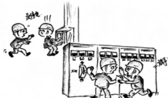
4、没有切断动力源并采取可靠措施，不得对设备进行检修和故障处理。
