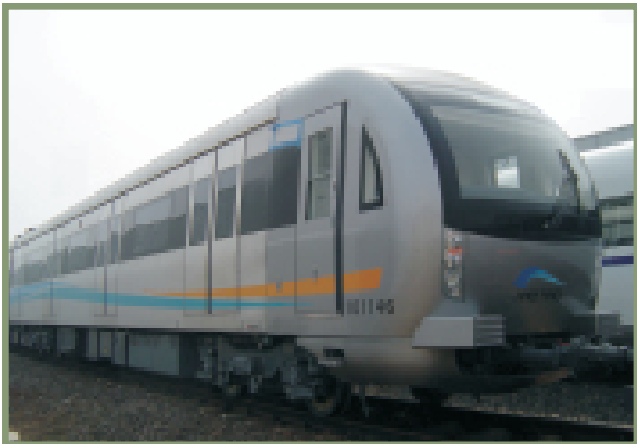
2005年，太钢研发的客车用不锈钢材料批量使用于北京地铁5号线、10号线等线路的车厢制造和时速200公里动车组车厢制造。
