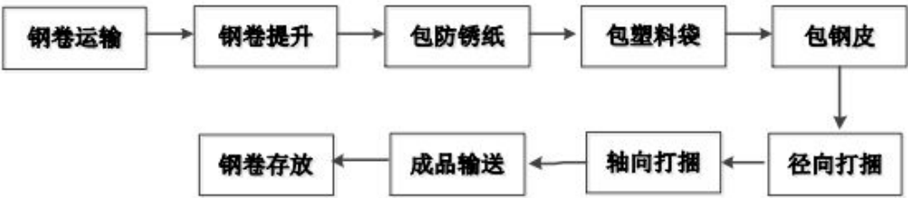
图 2-9 包装机组工艺流程及产排污图
