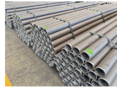
钛管冷轧成品管φ25×2mm
