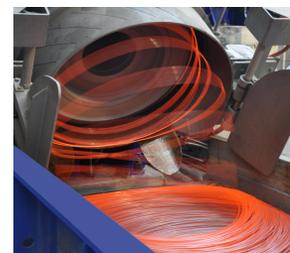
棒、线材减定径连轧机组
