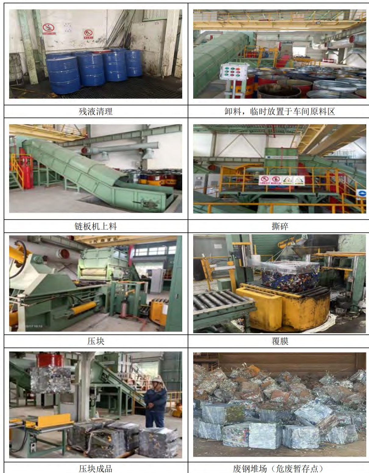
图 5.2-2 废桶压块工艺过程、废钢堆场临时堆存（待配料入炉）
