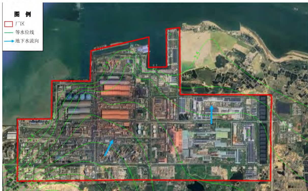
图 7.6-10 场地浅层地下水流场示意图
