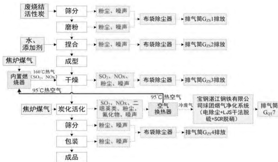
图 3.3-1 烟气净化用活性炭生产工艺流程
