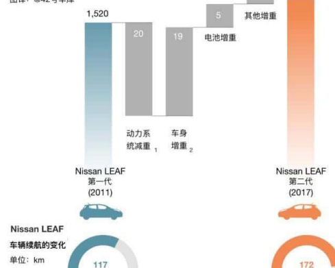
Nissan LEAF 车辆重量的变化, 单位: kg 图译: @42号车库
