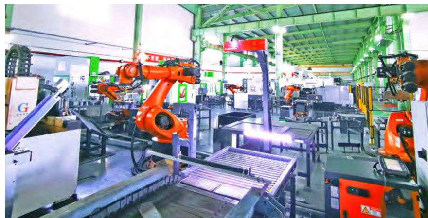
2020年11月18日，由宝武智维承接的湛江钢铁厚板实验室国内首条厚板试样加工全自动线顺利上线投运。该项目采用国内先进的加工设备，集成3D视觉、3D扫描、六轴机器人和自主引导机器人等智能设备，配以集成控制系统，实现厚板试样加工的自动化、柔性化及智能化。
