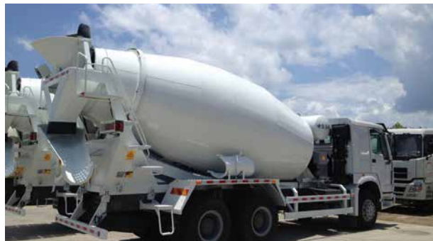
应用新型耐磨钢BW300TP的混凝土搅拌车
